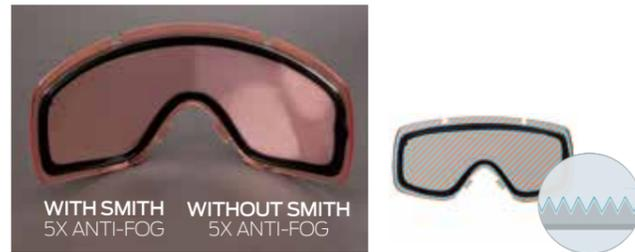
SMITHのアンチフォグインナーレンズの特徴は、他社のようなレンズ表面に曇り止め素材をコーティングしているのとは違い、レンズの表面に水分吸収の優れた素材を練りこみ且つ、目に見えないマクロの溝を彫り、これにより水分吸収の表面積を大きくしている。化学薬品のコーティングではないので剥がれることは無く、半永久的な機能をもつスミスのスタンダードな曇り止め加工。
